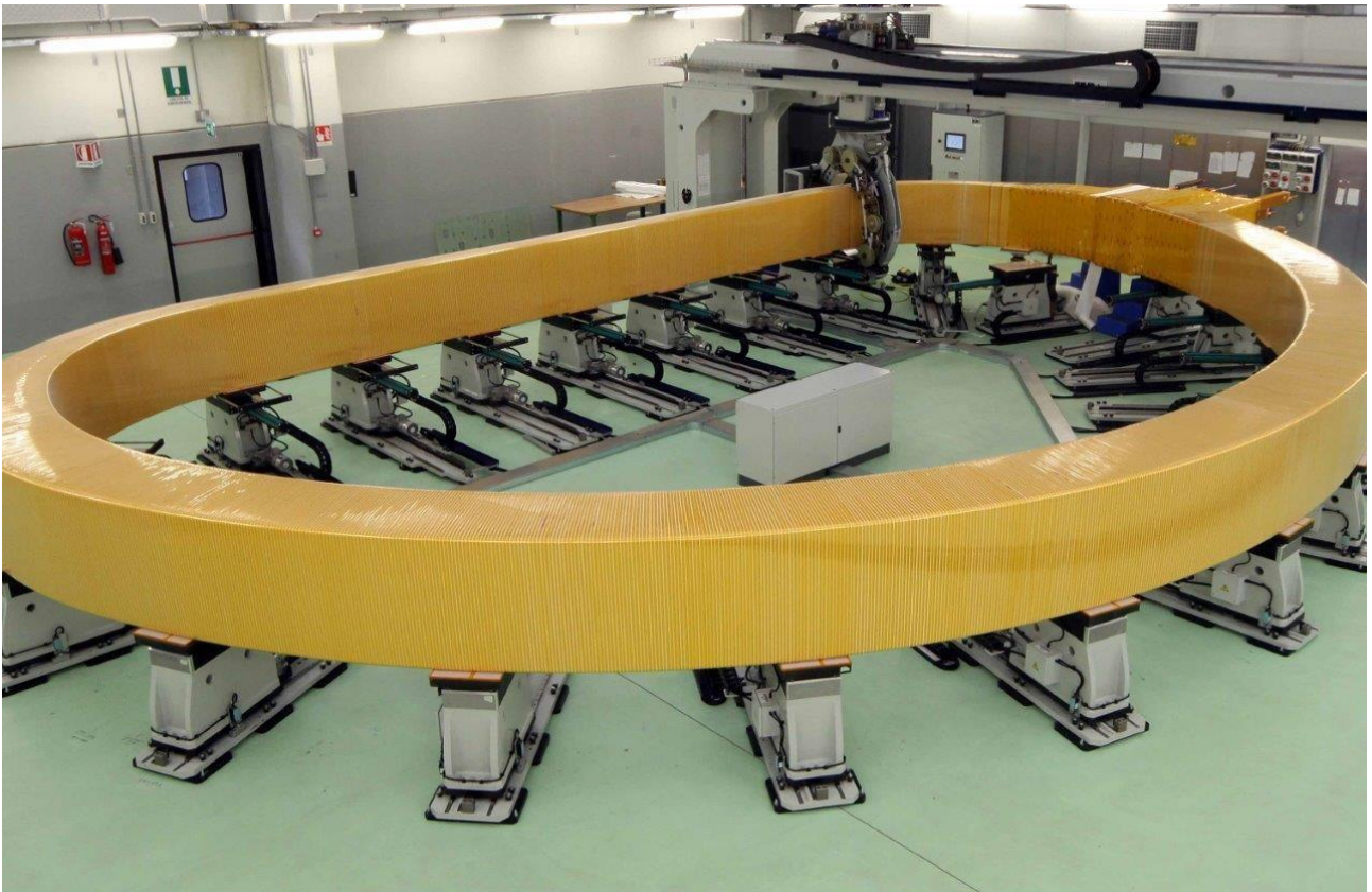
Avvolgimento della bobina toroidale della macchina ITER
